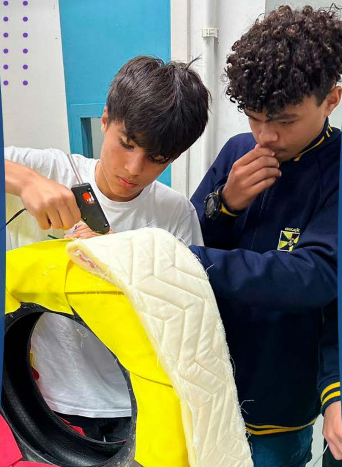
promover móveis personalizados. Os materiais utilizados incluíram pneus como base estrutural, tecidos para revestimento, espuma ou enchimento para conforto, bases de madeira ou MDF para estabilidade e cola ou grampeadores para fixação.
