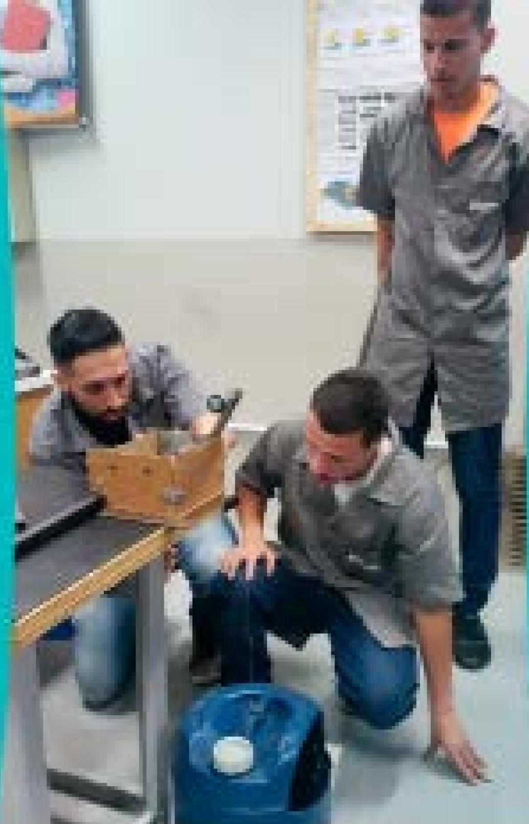
Com materiais como MDF, cedidos pelo professor, e levando em conta medidas externas, os estudantes criaram sete protótipos, superando expectativas e automatizando-os. Ao final, foi realizada uma competição para levantar carga, utilizando tarugos de aço de 2,7 kg. A equipe vencedora conseguiu levantar 32 kg, mostrando o sucesso do projeto. A atividade envolveu aprendizado prático, tornando os fundamentos teóricos mais dinâmicos e acessíveis.
