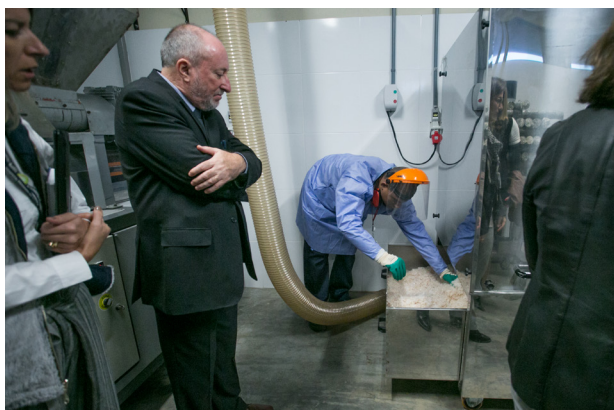
Polietileno triturado para ser transformado em sacos de lixo
