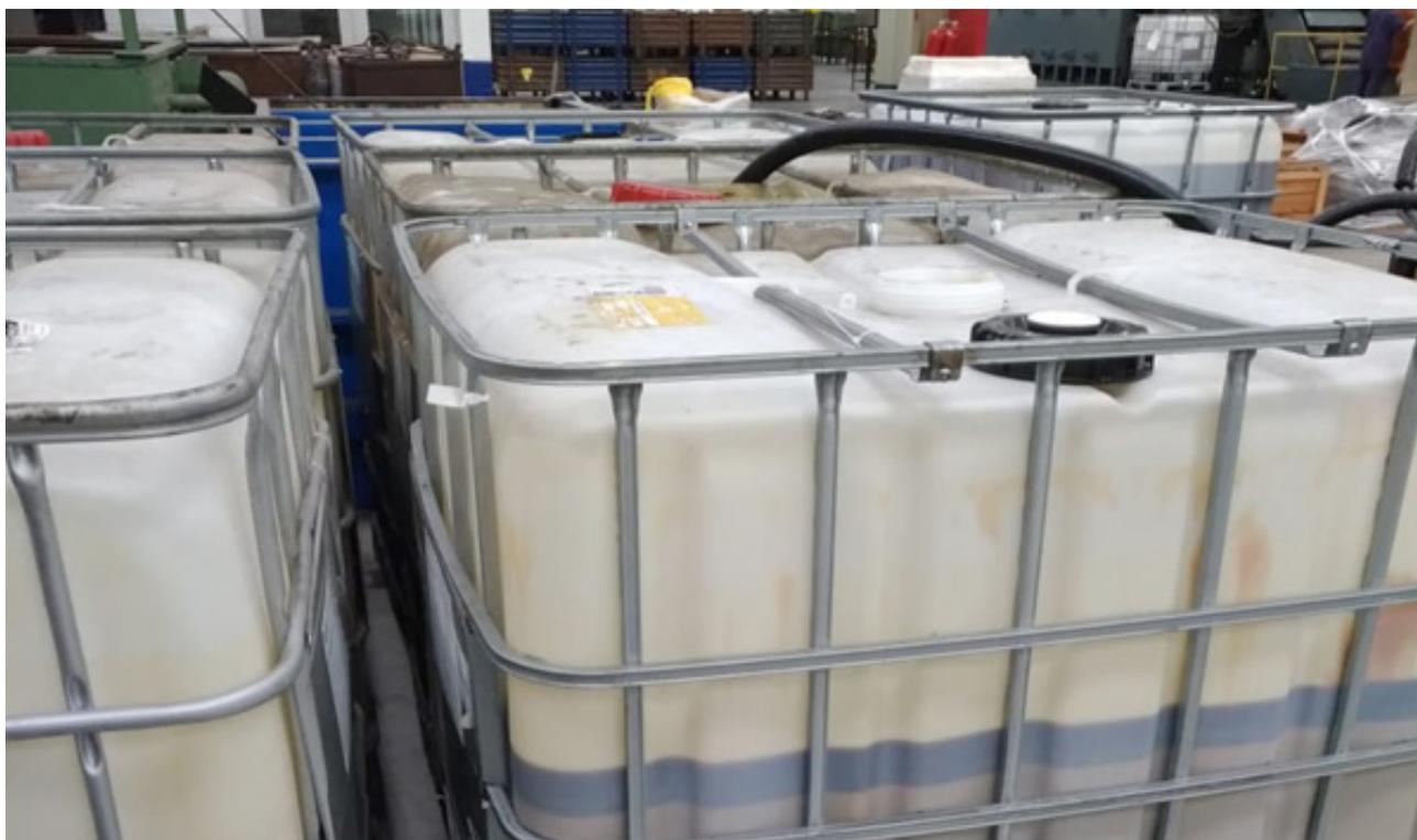
Área de armazenamento dos containers de água com óleo durante o período de decantação.
