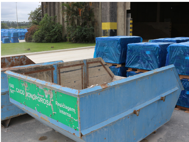
Acondicionamento de cacos cerâmicos em caçambas separados por tipologia
