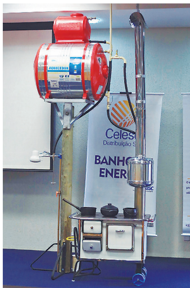
Banho de Energia utiliza o calor da chaminé para aquecer a água do chuveiro
